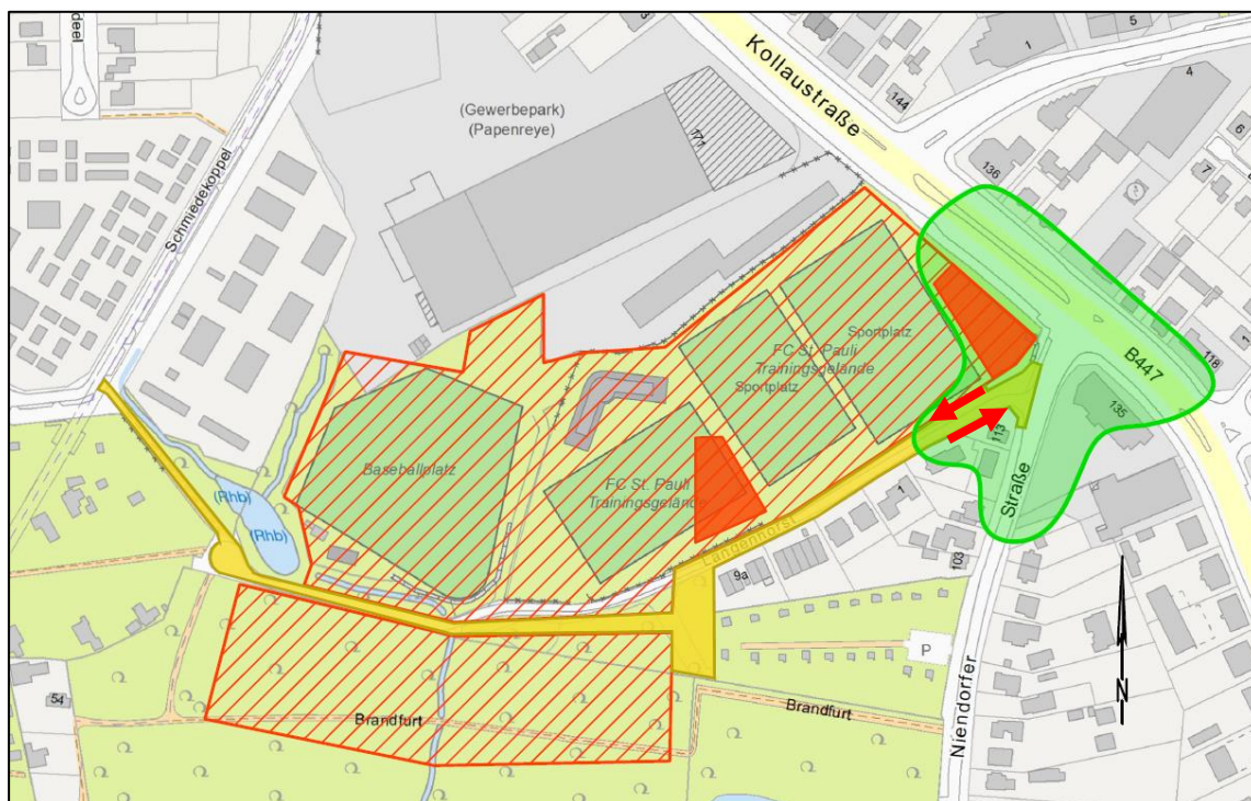
Abb. 1.3: Übersicht Planungsgebiet: geplante Funktionsgebäude (rot), geplantes Trainingsgelände (rot schraffiert), geplante Straßenverkehrsfläche (gelb), Untersuchungsgebiet Leistungsfähigkeit (grün), Untersuchungsquerschnitt Verkehrsbelastung Langenhorst (rote Pfeile)
