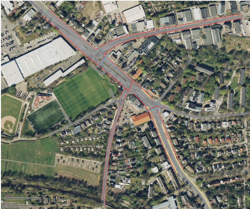
Abb. 4.3: Bildschirmfoto des Simulationsnetzes aus dem Verkehrsmodell in VISSIM
